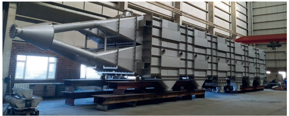
Der hier gelieferte Wärmeübertrager aus sechs Elementen kommt im Prozess der Festphasentrocknung und -konditionierung von Polymeren zum Einsatz
