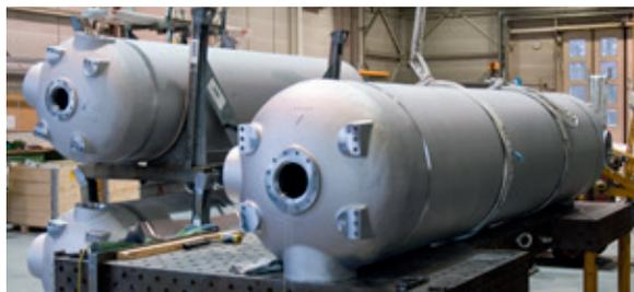
Vasos e tanques de aços resistentes à corrosão e materiais cladeados
