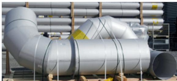
Tubulações pré-fabricadas de aços resistentes à corrosão
